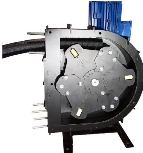
Рис. Установка рабочего шланга
