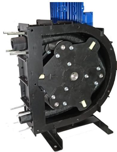
Рис. Установка рабочего шланга
