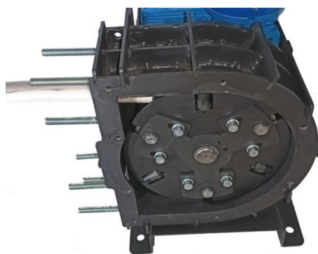
Рис. Установка рабочего шланга
