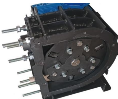
Рис. Установка монтажных пластин и штуцеров
