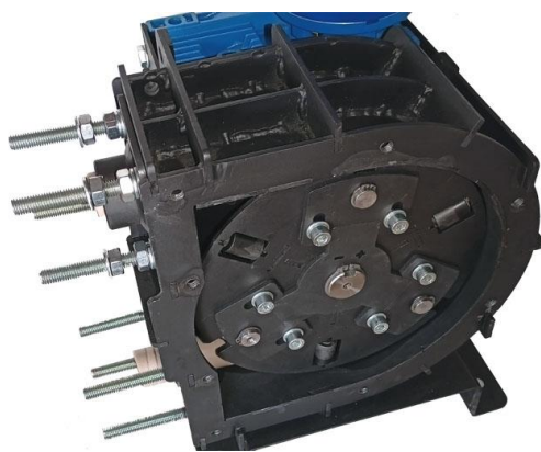
Рис. Установка монтажных пластин и штуцеров
