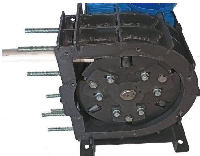
Рис. Установка рабочей трубки
