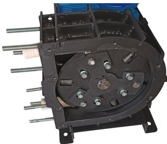
Рис. Установка рабочей трубки
