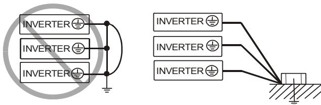
Рис. 2- 4 Заземление (G)
