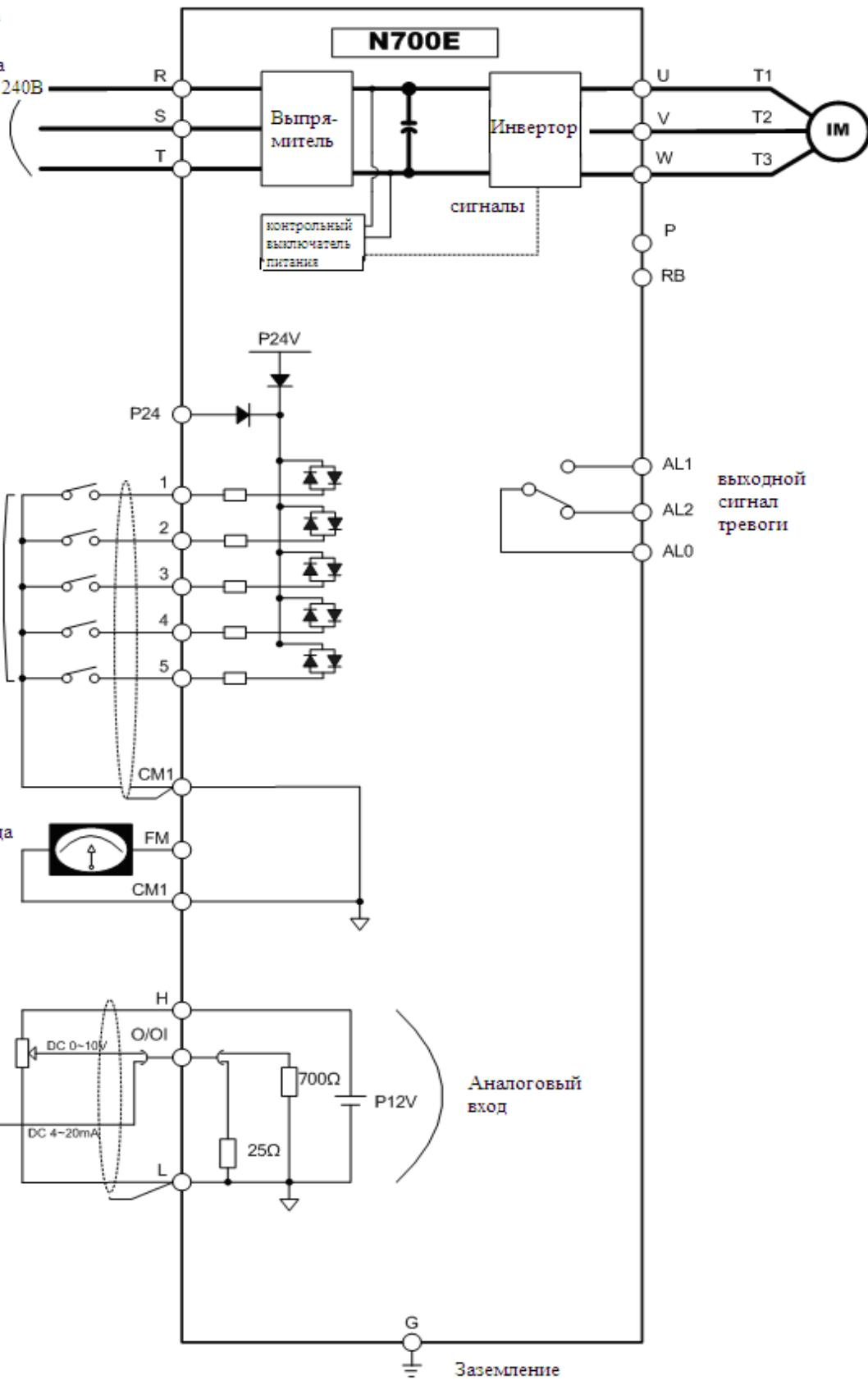
Рис.2-3 Схема подключения клемм
