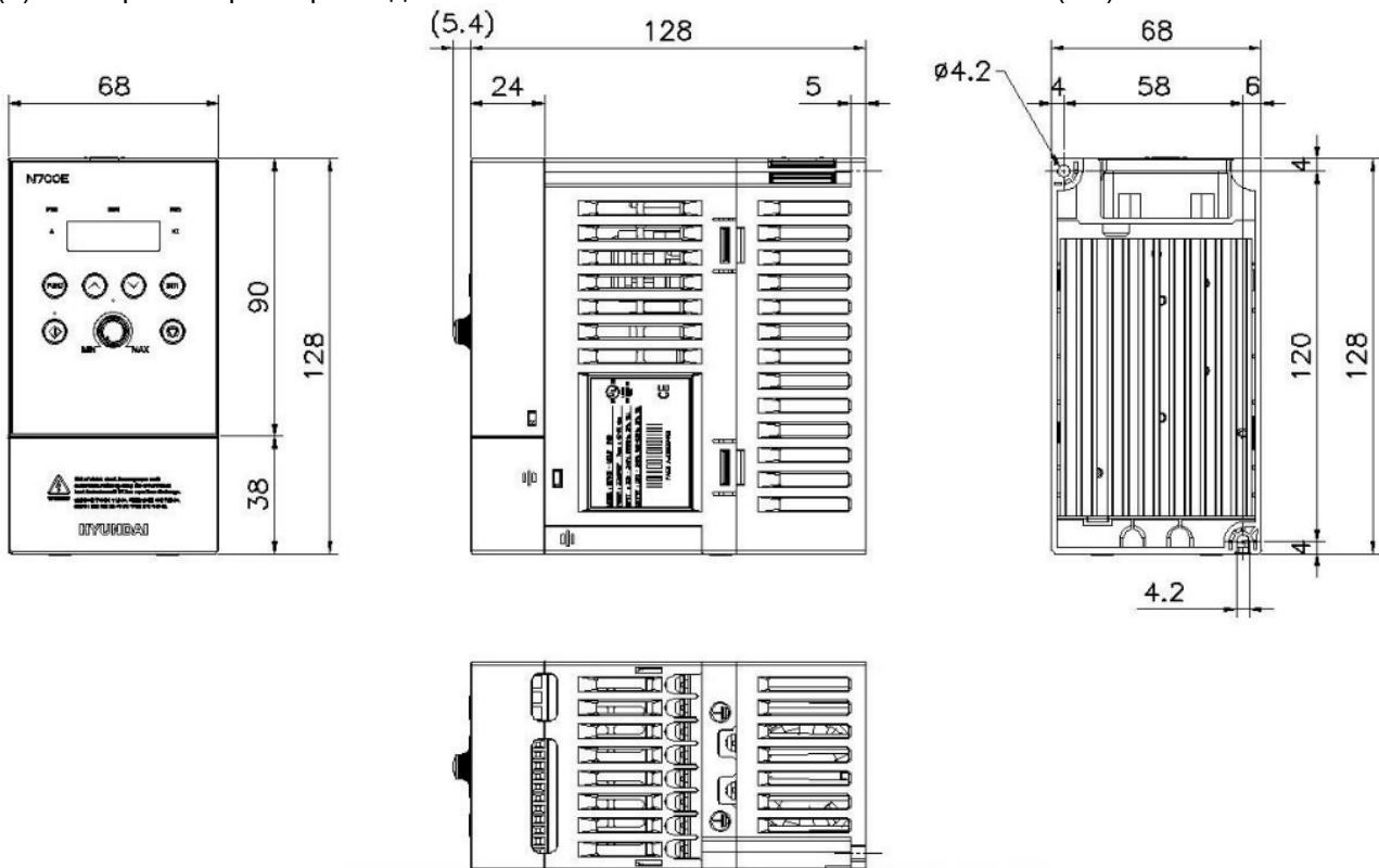
(2) Габаритные размеры моделей N700E-015SF/004HF/007HF/015HF/022SF/022LF/022HF (мм).
