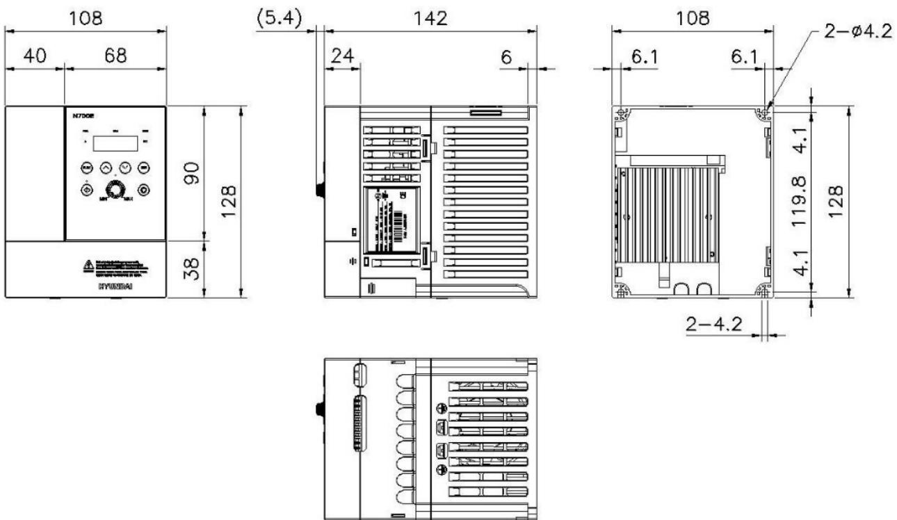
(3) Габаритные размеры моделей N700E-037LF/037HF (мм).
