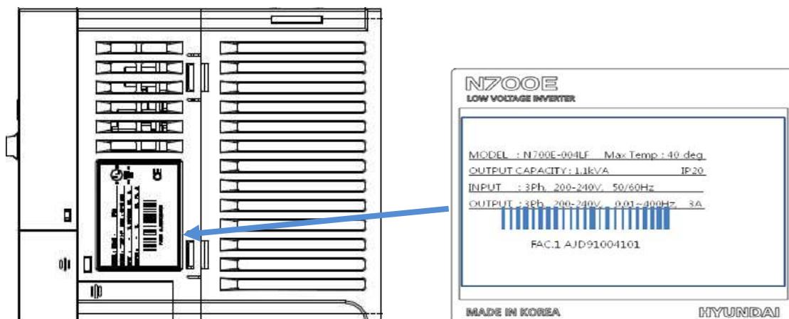
Рис.1-2 Табличка с техническими характеристиками инвертора
