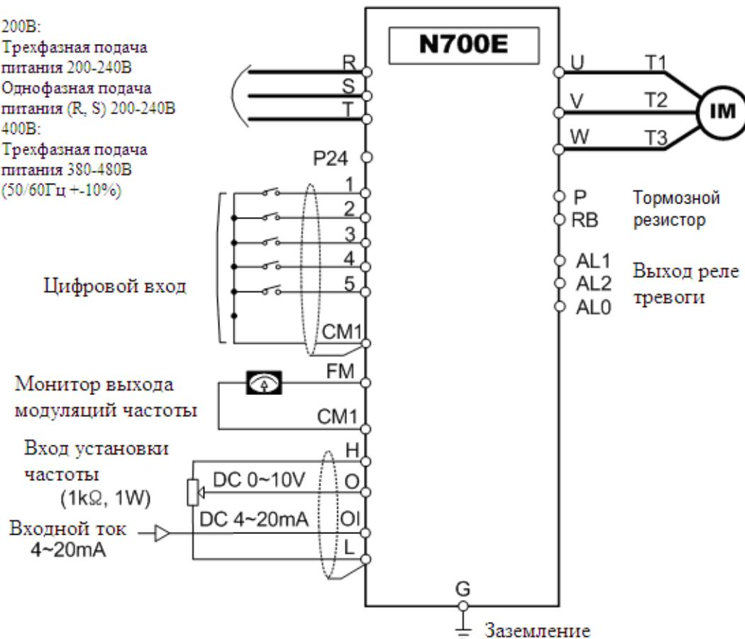
Рис. 3-1 Схема установки команд с помощью клемм управления
